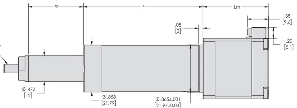
1. Molex-Stecker 53253-0670 abgebildet. Kabelsatz mit Molex 51065-06000 Stecker und losen Kabelenden mit Motor enthalten. Verdrahtungsplan und Anschlussangaben siehe Seite 45.
