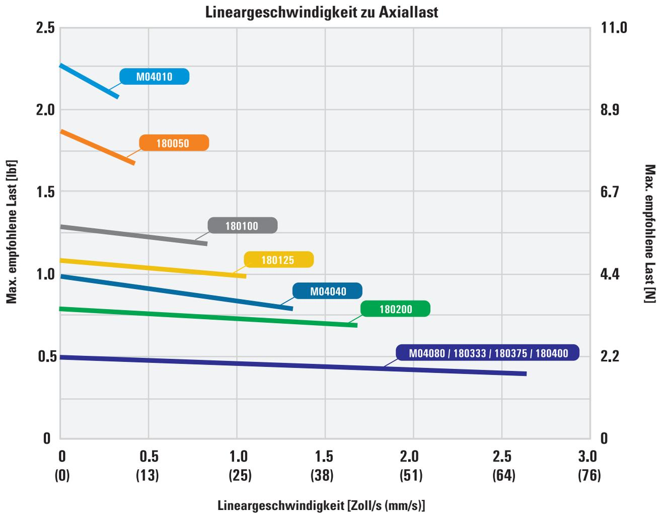
Hinweis: Vereinfachte Leistungsdiagramme sind nur theoretisch und gehen von Idealbedingungen aus: 24-VDC-Stromversorgung, Mutter aus Standardmaterial, ungeschmierte Spindel mittlerer Länge. Höhere Lasten und Geschwindigkeiten sind möglich. Genauere Leistungsdiagramme und Auslegungstools finden Sie auf [www.thomsonlinear.com/de/produkte/motorized-trapez-gewindetriebe](http://www.thomsonlinear.com/de/produkte/motorized-trapez-gewindetriebe).
