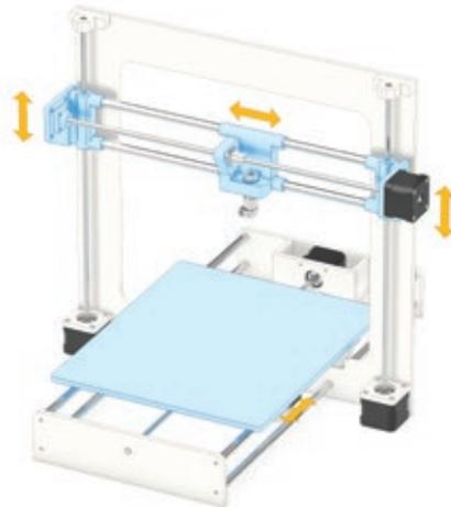
Ein Schrittmotor-Linearantrieb in einem 3D-Drucker macht Kupplungen, Lager und Abstützungen überflüssig – bei mehr Hublänge und Druckvolumen.
