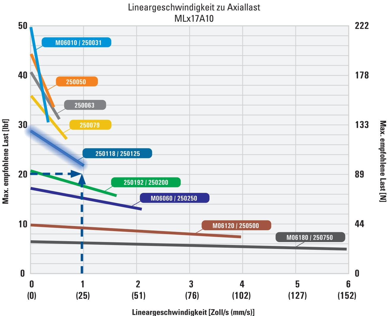
Bei den Vorgaben von 89 N bzw. 25 mm/s ist die ideale Spindel eine 250118 oder 250125 mit diesem Motor.
