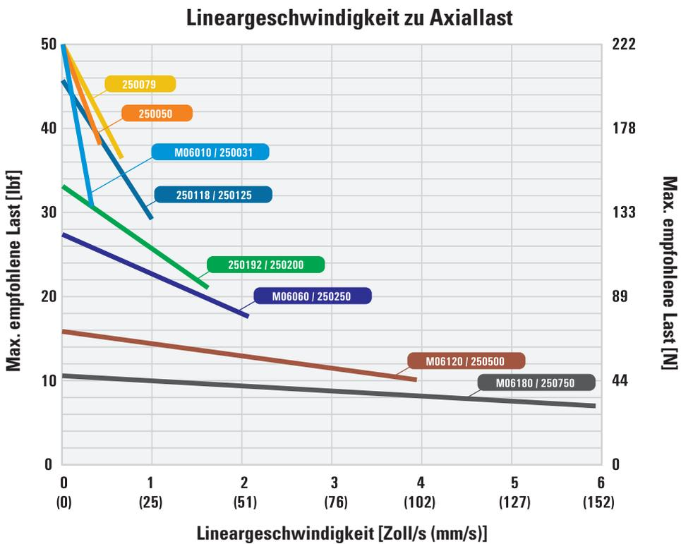
Hinweis: Vereinfachte Leistungsdiagramme sind nur theoretisch und gehen von Idealbedingungen aus: 24-VDC-Stromversorgung, Mutter aus Standardmaterial, ungeschmierte Spindel mittlerer Länge. Höhere Lasten und Geschwindigkeiten sind möglich. Genauere Leistungsdiagramme und Auslegungstools finden Sie auf [www.thomsonlinear.com/de/produkte/motorized-trapez-gewindetriebe](http://www.thomsonlinear.com/de/produkte/motorized-trapez-gewindetriebe).
