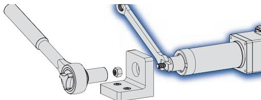
Verwenden Sie beim Anbau ihrer Last an das Montageende einer MLA-Einheit grundsätzlich die vorgesehenen Abflachungen, um ein Überdrehen und Beschädigen der Aktuator-Komponenten zu vermeiden.
