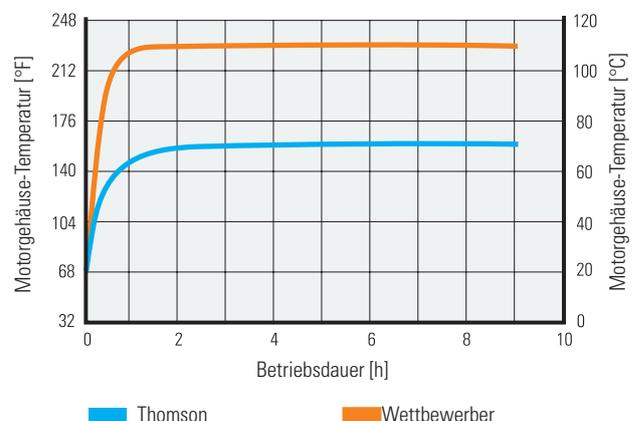
Die Kennlinien wurden mit einem 1-Stack-Schrittmotor (1,5 A / 2,33 V; 1,8°; NEMA 17) mit angetriebener Spindel generiert. Der Test erfolgte mit einem Chopper-Verstärker (0,9°, 24 VDC) und einer Gewindespindel Typ 4-2516 bei einer Umgebungstemperatur von 20 °C.
