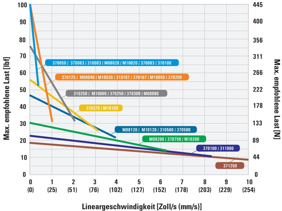
Hinweis: Vereinfachte Leistungsdiagramme sind nur theoretisch und gehen von Idealbedingungen aus: 24-VDC-Stromversorgung, Mutter aus Standardmaterial, ungeschmierte Spindel mittlerer Länge. Höhere Lasten und Geschwindigkeiten sind möglich. Genauere Leistungsdiagramme und Auslegungstools finden Sie auf [www.thomsonlinear.com/de/produkte/motorized-trapez-gewindetriebe](http://www.thomsonlinear.com/de/produkte/motorized-trapez-gewindetriebe).
