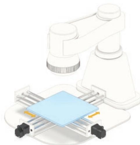
Schrittmotor-Linearantriebe optimieren Kreuztische durch ihre Kompaktheit und Leistungsstärke.
